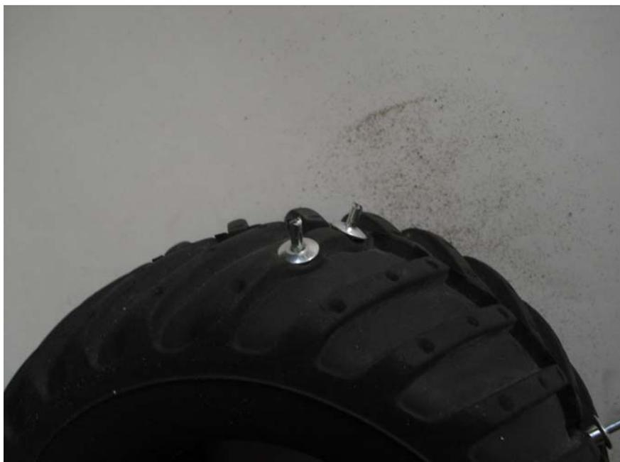
Schritt 7: Schaumgummi wieder in die Reifen legen und Felgen einsetzen. Reifen sauber mit den Felgen verkleben. Fertig
