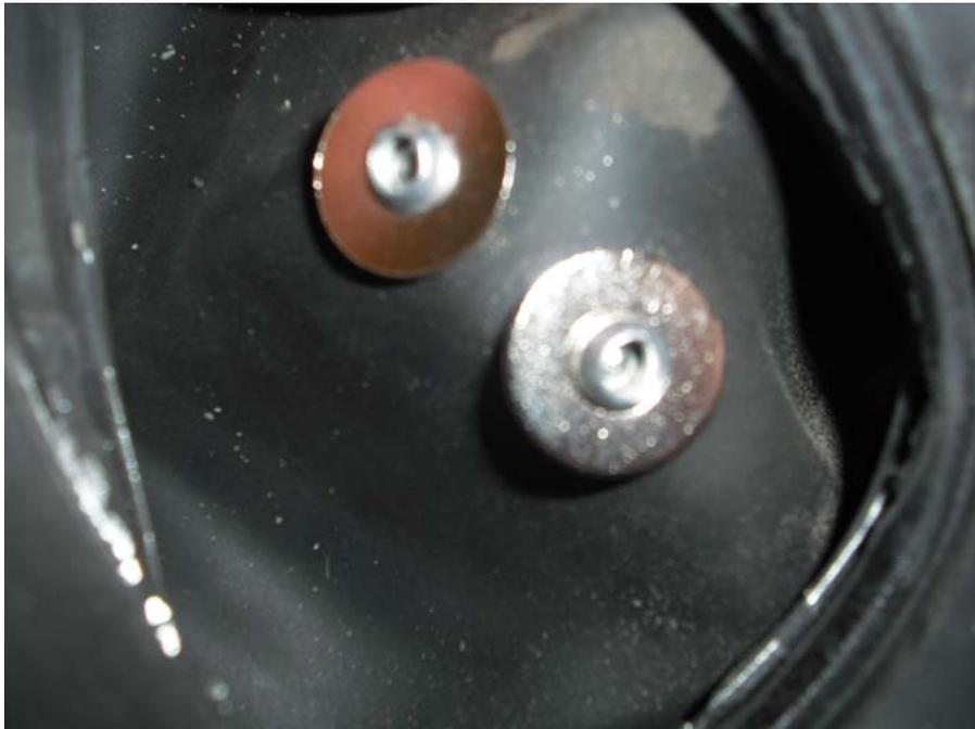
Schritt 6: mit dem Seitenschneider die Blindnietenstifte auf die gewünschte Länge abzwicken
