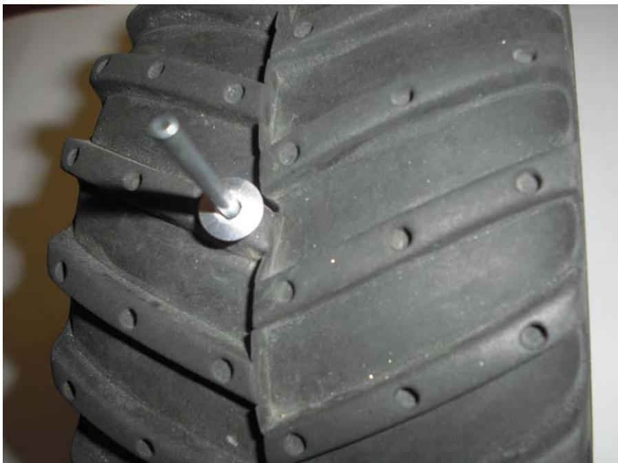
Schritt 5: Die Beilagscheiben im inneren der Reifen auf die Blindnieten legen und mit der Blindnietenzange fest ziehen ohne dabei den Nietstift abzuzwicken
