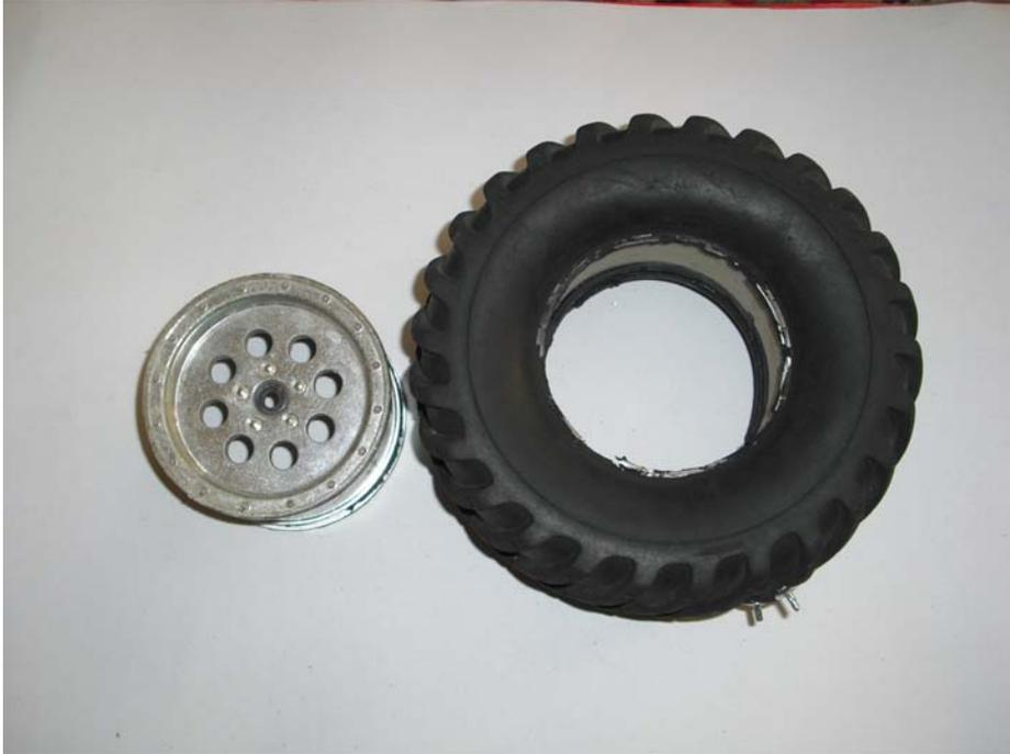
Schritt 2: Schaumgummi aus den Reifen entfernen
